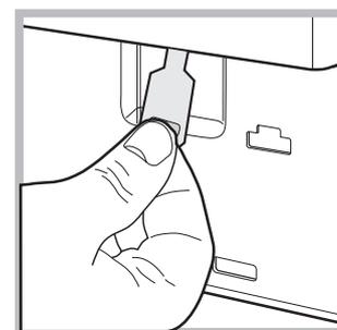
4. pociągnąć na zewnątrz klapkę wskazaną na rysunku, aż do wyzwolenia się z zacisku plastikowego zaczepu; następnie pociągnąć go w dół i równocześnie otworzyć drzwiczki.
